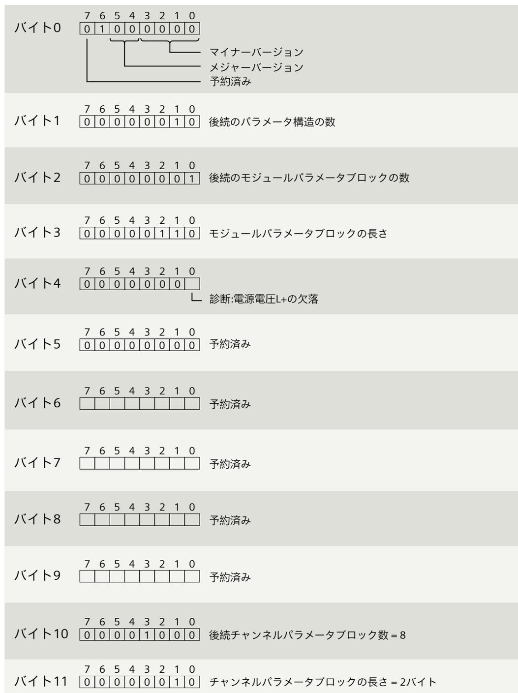
図 A-2 データレコード 128 のヘッダー情報およびモジュールパラメータ
