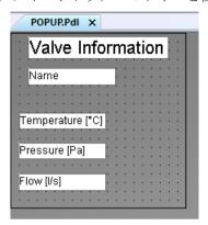
5. [I/O フィールド]タイプの 3 つのオブジェクトを挿入し、各ケースのフィールドタイプとして [出力]を選択します。[タグ]フィールドを空にしておきます。
