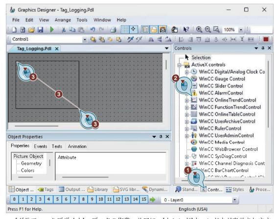
[グラフィックデザイナ]エディタの作業エリアに、[トレンド]ウィンドウが表示されます。 [WinCC OnlineTrendControl のプロパティ]ダイアログが開きます。
