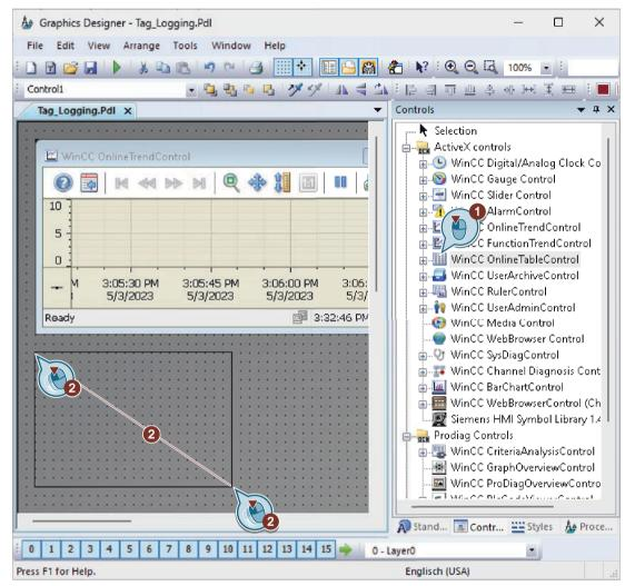
[グラフィックデザイナ]エディタの作業エリアに、[テーブル]ウィンドウが表示されます。 [WinCC OnlineTableControl のプロパティ]ダイアログが開きます。
