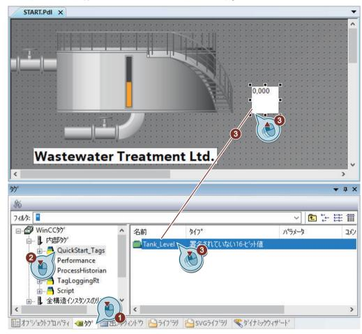
I/O フィールドが選択されたタグに対して作成されます。I/O フィールドは、[Tank\_Level]タグと接続されています。
