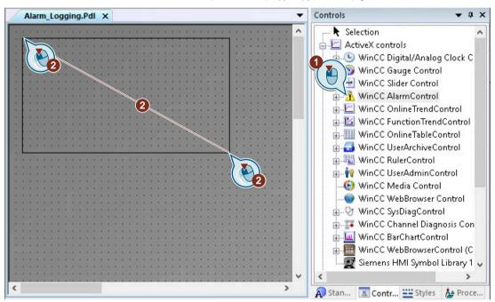
[WinCC AlarmControl プロパティ]ダイアログが開きます。
