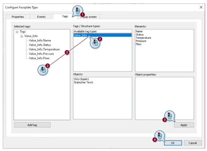
構造タイプがインターフェースタグとして定義されています。 フェイスプレートタイプのダイナミック化を行うために、インターフェースタグを使用します。
