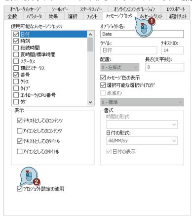
5. [メッセージリスト]タブをクリックします。 ユーザーテキストブロック[メッセージテキスト]および[エラーのポイント]を[選択されているメッセージブロック]フィールドに移動します。
