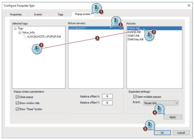
3. 設定を保存するには、[適用]をクリックして、[はい]で確定します。 画像がポップアップ画面として設定されています。
