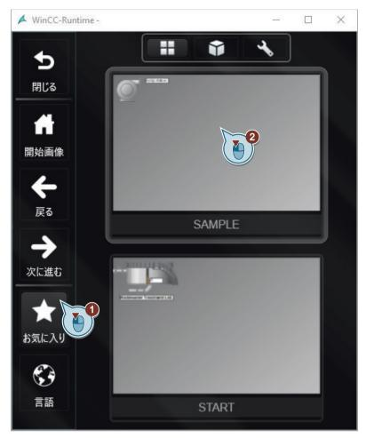
ランタイムシステムダイアログが非表示になり、「SAMPLE.Pdl」プロセス画像が表示されます。
