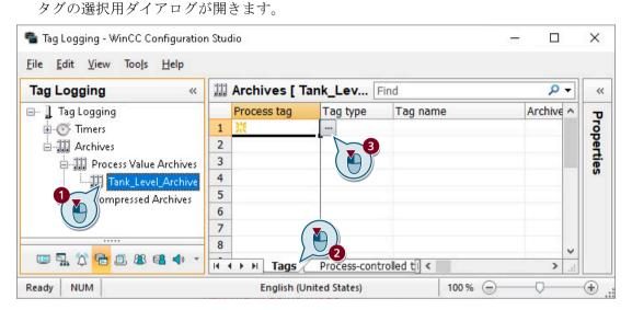
5. 内部タグ[Tank Level]を[QuickStart Tags]タググループで選択します。
