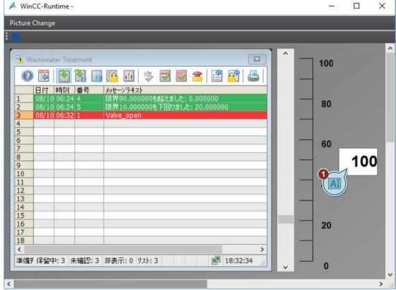
タグ値の2番目のビットが設定されます。 ディスクリートアラーム"Valve open"が表示されます。
