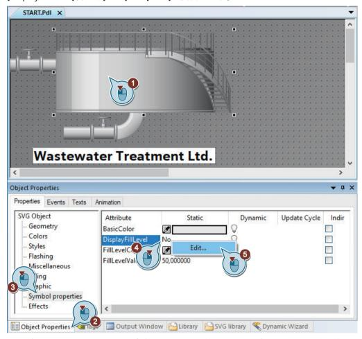
バーグラフが[Digester] SVG オブジェクトで、充填レベルインジケータとして表示されます。
