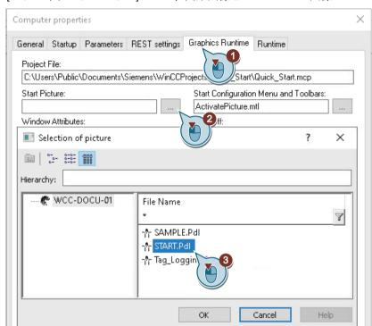
3. [グラフィックランタイム]タブで、開始画像としてプロセス画像「START.Pdl」を定義します。
