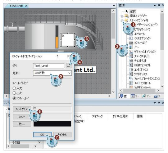
I/O フィールドのショートカットメニューから[設定ダイアログ]を選択することで、[I/O フィールド設定]ダイアログを再度開きます。
