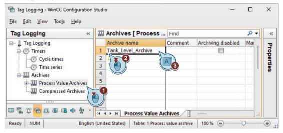
3. ナビゲーションエリアで、アーカイブのフォルダを選択します。 テーブルエリアで[タグ]タブを選択します。
