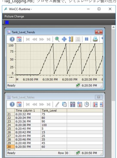
4.「Tag Logging.Pdl」プロセス画像で、シミュレーション値の出力を監視します。
