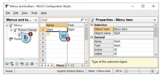
5. メニュー項目[開始]を設定して、「START.Pdl」画像に画像変更を実行できるようにします。
