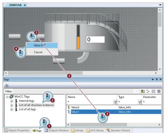
フェイスプレートインスタンスがプロセス画像に配置されていて、「Valve1」構造インスタンスの構造タグとダイナミック化されています。
