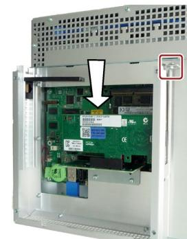
5. PCIe カードホルダを PCIe カードの方向に押し込み、マークされたネジでこれを固定します。
