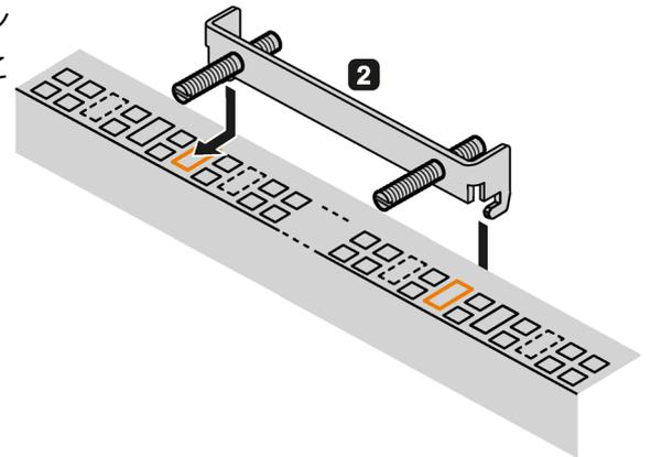
3. ねじ山のあるピンで取り付けブラケットを締め付けます。最大許容トルクは0.5 Nm です。
