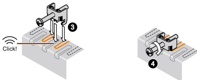
4. 取り付けクリップを固定するには、スロットスクリュードライバを使用して止めネジを締め付けます(トルク 0.5 Nm)。
