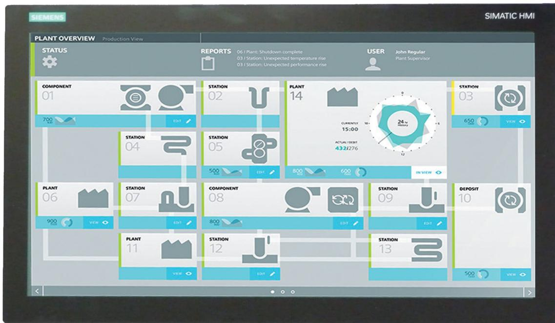
図 1-2 容量性マルチタッチスクリーンを備えた装置
