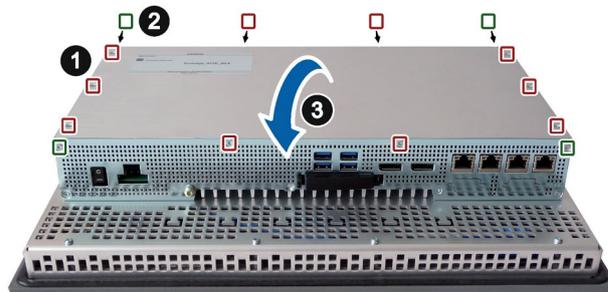
3. 装置の背面パネルを外します。
