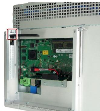
4. PCIe カードを矢印の方向に挿入し、マークされたネジでこれを固定します。
