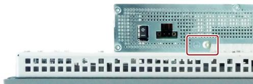
3. 保護導体を、装置が取り付けられている制御キャビネット保護導体接続部に接続します。
