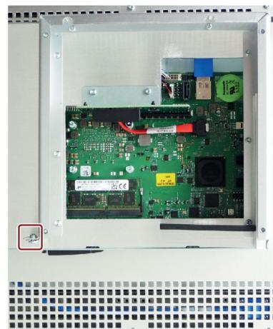
3. PCIe カードホルダーの強調表示されているネジを取り外します。
