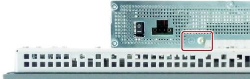
2. ケーブルラグを目標の保護導体接続のネジに接続します。
