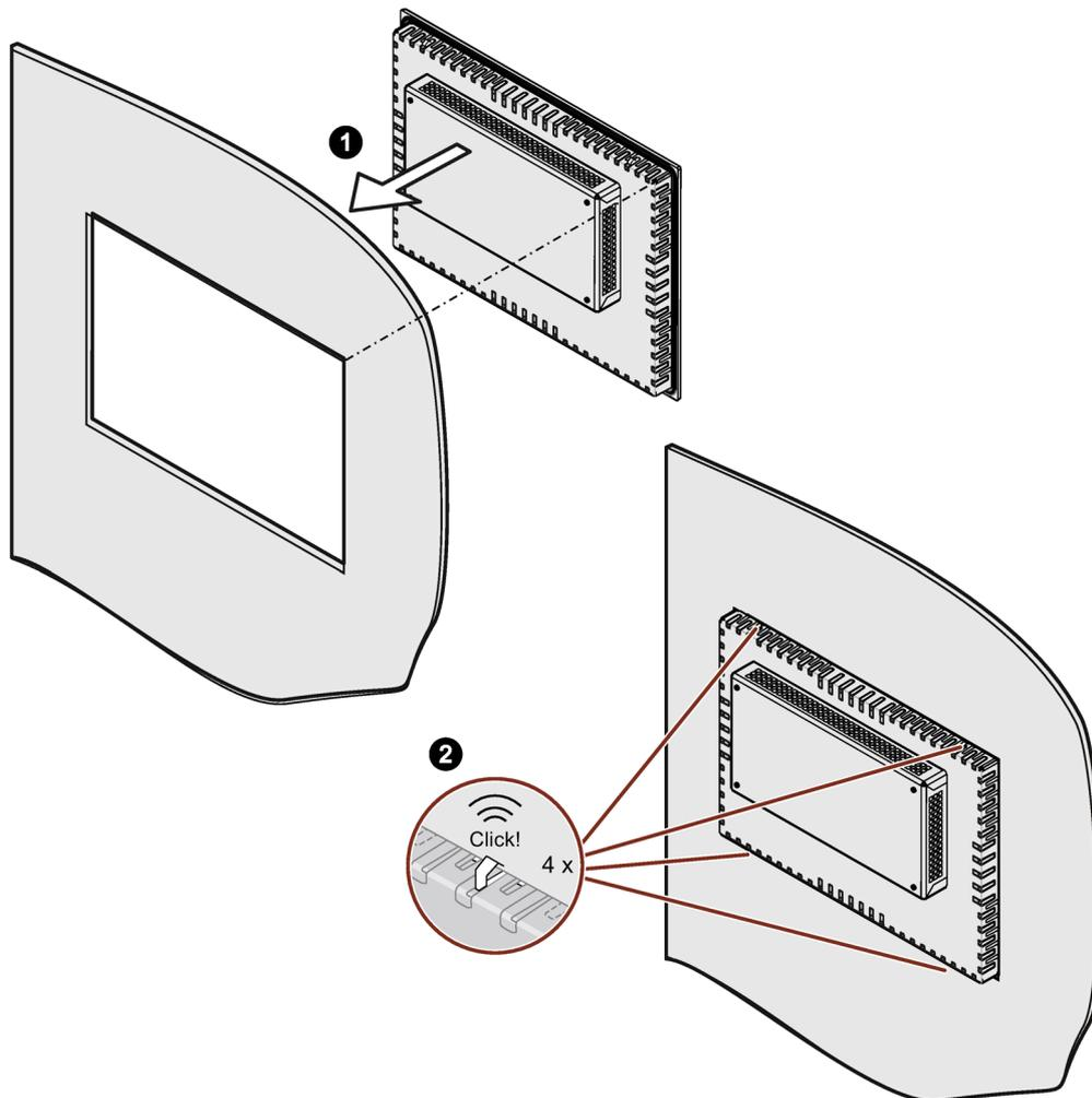
2. 4つのスプリング留め具ラッチすべてが装置の上部と下部の所定の位置に完全にはめ込まれていることを確認してください。必要な場合、装置を、完全にラッチがかみ合っていない所定の位置の取り付けスロットに押し込みます。
