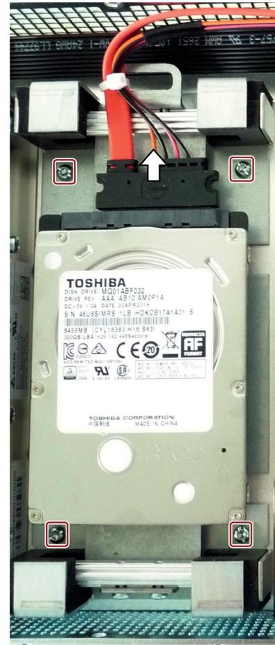
4. ハードディスクをベースプレートから外します。ハードディスクおよびベースプレートを接続している 4 つのネジを外します。
