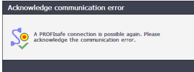
起動ボタンを押して通信エラーを確認するか、フェイルセーフコントローラの通信エラーを確認します。
