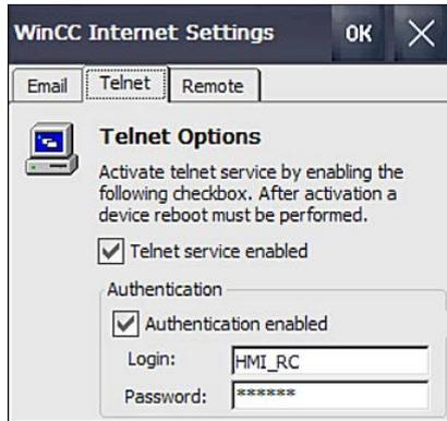
3. Telnetサービスを使用したい場合、[Telnet service enabled]を選択します。
