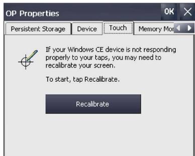
3. [Recalibrate]ボタンを押します。以下のダイアログが表示されます。
