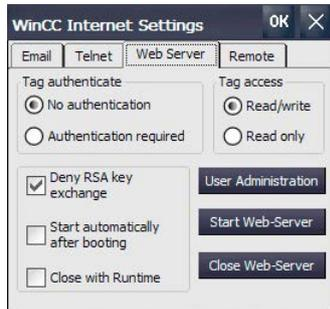
3. [Tag access]グループで、HMIデバイスサーバーのタグへのアクセスタイプを定義します。
