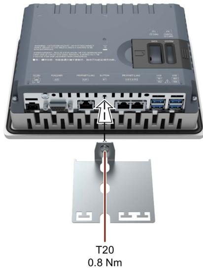
15インチ以下のディスプレイを装備したHMIデバイス
